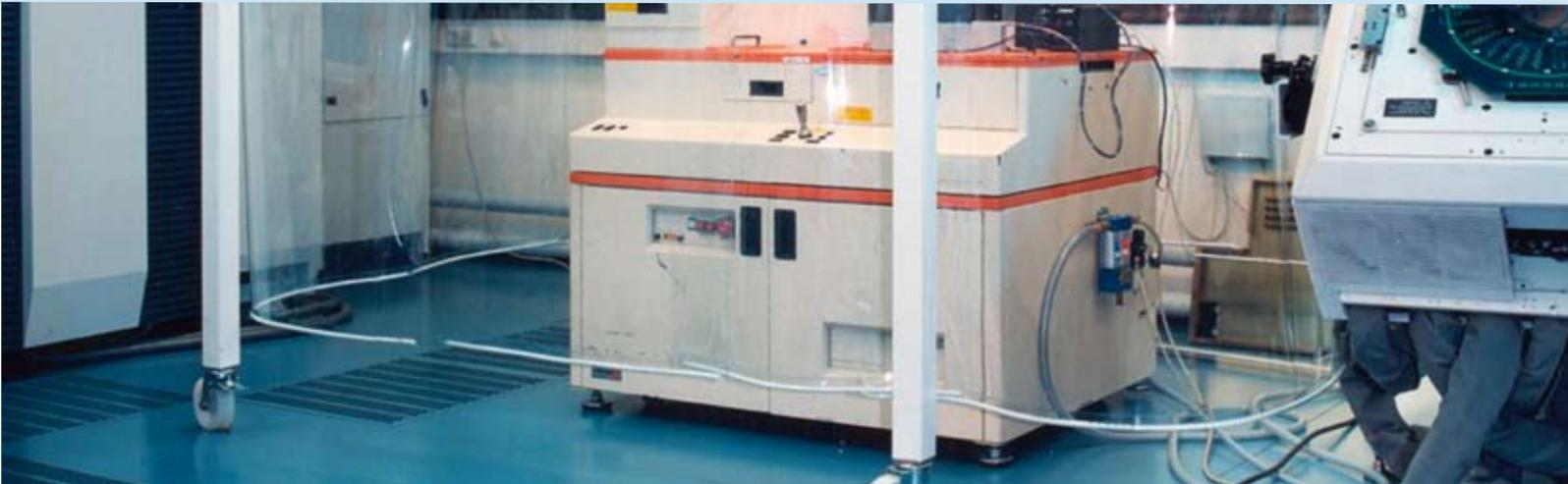
Die Kabinen und Zelte sind dank des flexiblen Flowmodul-Stecksystems für nahezu jeden Einsatz bestens geeignet. Alle Systeme und Produkte entsprechen den Anforderungen der Reinheitsklassen nach US Federal Standard 209e sowie den VDI-Richtlinien 2083. Eine nachträgliche Aufrüstung in eine höhere Reinraumklasse ist jederzeit problemlos möglich.
