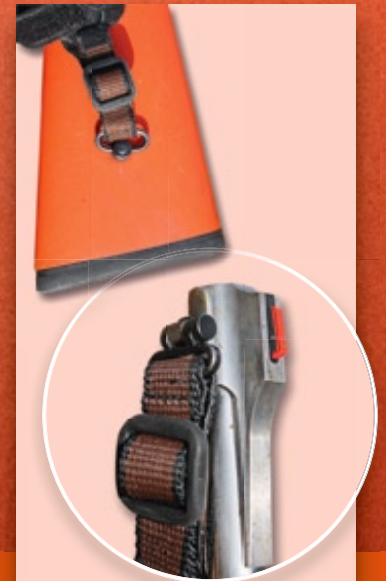
Seitliche Riemenbefestigung am Lauf und am Schaft sind Pflicht bei einer Nachsuchenwaffe.
