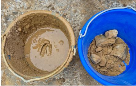
Der Flüssigboden (links) verfestigt sich innerhalb weniger Tage vollständig.
