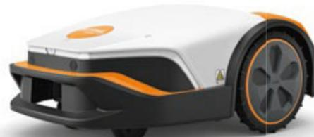
Vollautomatischer Mähroboter für große Rasenflächen, schneidet, zerkleinert und düngt als Mulchmäher in einem Arbeitsgang. Sauberes Schnittbild durch 3 freischwingende Klingen, elektrische Schnitthöhenverstellung und situativ angepasste Fahrgeschwindigkeit. Steigfähigkeit bis zu 40 %. Schnittbreite 28 cm. Intuitive Bedienung. Zugriff per MY iMOW® App mit Bluetooth® und WLAN.
