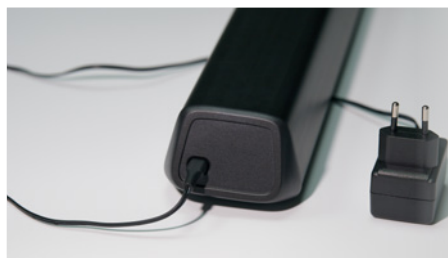
Zadní strana B.Control Dog s portem USB-C pro nabíječku
