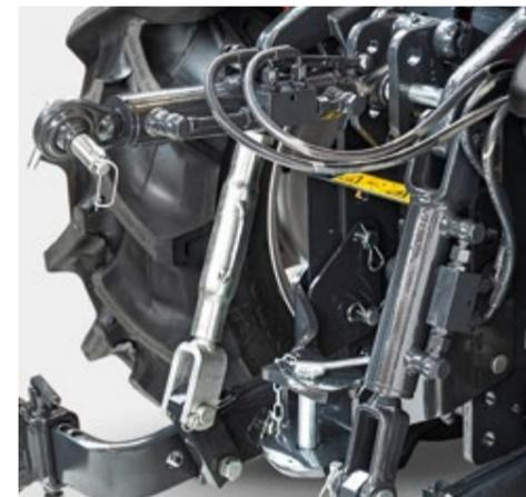
**HYDRAULISCHE HUBSTREBE UND DREIPUNKT\***
