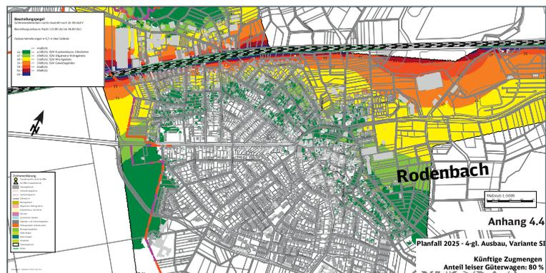
Schienenverkehrslärm nach dem viergleisigen Ausbau am Beispiel Rodenbach.
