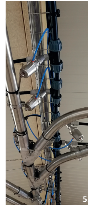
5. Die Rohrweichen sind komplett aus Edelstahl gefertigt und werden elektropneumatisch betätigt. Mittels elektropneumatischen Rohrweiche (komplett aus Edelstahl 1.4301) können, bedingt durch ein verbessertes Fließverhalten, auch CCM-haltige Futtermischungen problemlos gefüttert werden. Die Rohrweiche kann gleichermaßen als Weiche (Verteilung hinter Zellenradschleuse in Stichleitungen 2, 3, 4 usw.) oder als Ausdosierventil verwendet werden. Sie kann in fast jeder räumlichen Lage eingebaut werden bei einfachster Montage durch ein Einrohr-System.
