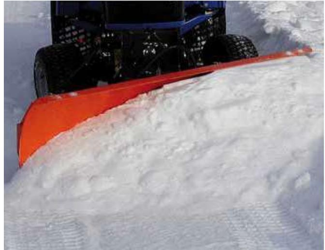
Durch eine Schrägstellung von bis zu 30°, wird ein optimales Räumergebnis erzielt.
