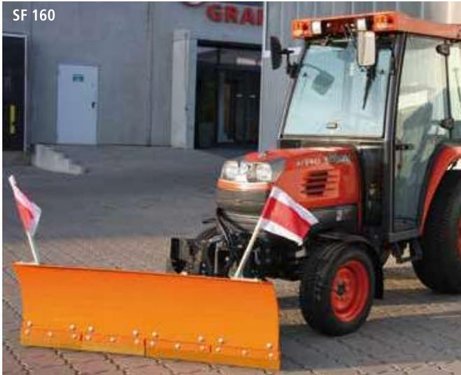
Die Gartenland-Schneeräumschilder mit Vulkolanbesatz werden eingesetzt für die Schneeräumung im Winterdienst. Die äußerst verwindungssteifen Räumschilder sind serienmäßig mit Federklappensegmenten als Überfahrtsicherung ausgerüstet. Ebenfalls serienmäßig dabei ist der Niveauequaler, die höhenverstellbaren Gleitpilze, Warnfahnen und die hydraulische Seitenverstellung. Das höhenverstellbare Kuppeldreieck sorgt für eine optimale Einstellung an jedem Kleinschlepper mit Kuppeldreieck Kat Kommunal.
