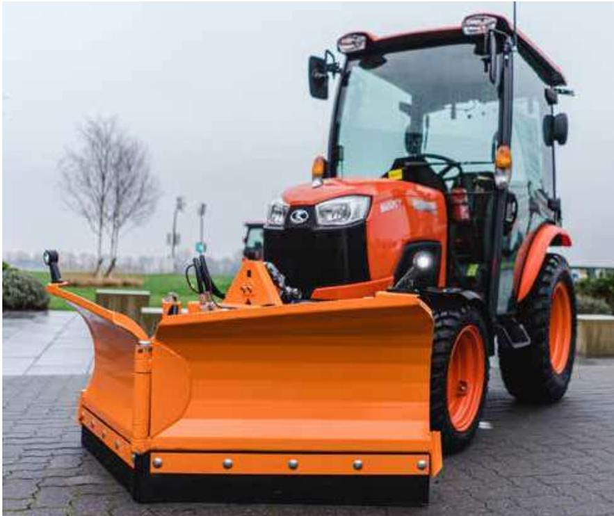
Das Gartenland-Vario-Schneeräumschild GL-Vario unterstützt sie im Winterdienst beim professionellen Räumen in schwierigen Situationen. Durch die variablen Einschwenkmöglichkeiten nach rechts und links, sowie in V- und Y-Form, befreien Sie einfach und effektiv Rad- u. Gehwege sowie Park- u. Gewerbeflächen.
