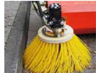
hydraulisch angetriebener Seitenbesen (optional)
