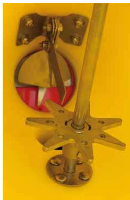
zusätzliches Rührwerk gegen Brückenbildung
