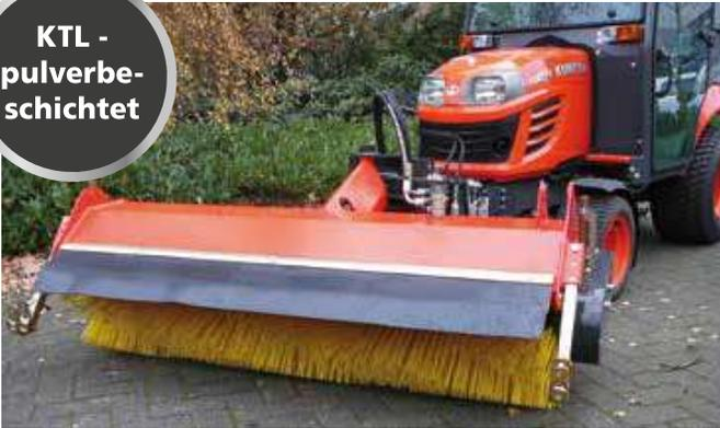
Die Gartenland-Kehrmaschinen GLFKM sind durch ihre kompakte und robuste Bauweise bei geringem Eigengewicht das ideale Gerät für Klein- / Kommunal-schlepper. Durch den serienmäßigen Niveauegleich und die Schwenkconsole wird ein sauberes und ganzflächiges Arbeiten garantiert. Die Universalkkehrwalze mit einem großen Durchmesser von 450 mm garantiert eine lange Standzeit und ein hervorragendes Kehrergebnis bei Schmutz und Schnee.
