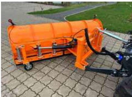
Federklappen als Überfahrerschutz, höhenverstellbare Stützräder
