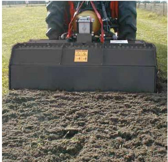
Altrasen, Steine und härteste Schollen werden in den Boden eingearbeitet. Schon nach einem Arbeitsgang liegt die Feinerde oben. Steine einsammeln entfällt. Der Zeitgewinn bei der Bodenbearbeitung ist enorm. Da der Antrieb außerhalb der Arbeitsfläche liegt, entstehen keine unbearbeiteten Streifen.
