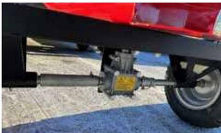
Verstärktes Metallgetriebe mit zuschaltbarem Freilauf für Überführungsfahrten
