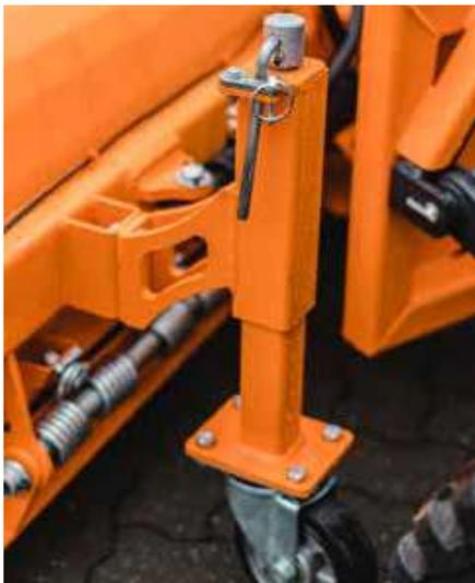
stufenlos höhenverstellbare Stützräder
