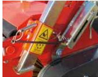
Abstellstütze und stufenlos höhenverstellbare Kehrwalze
