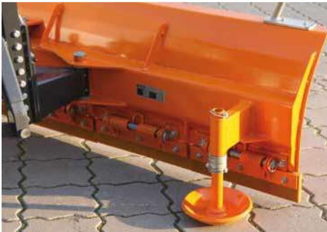
**Federklappen und verstellbare Gleitpilze.**
