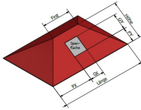
**Dach**    Ziegelart    Konterlattung Höhe    Aufdachdämmung Höhe    Sparrenabstand    Anzahl Sparren
