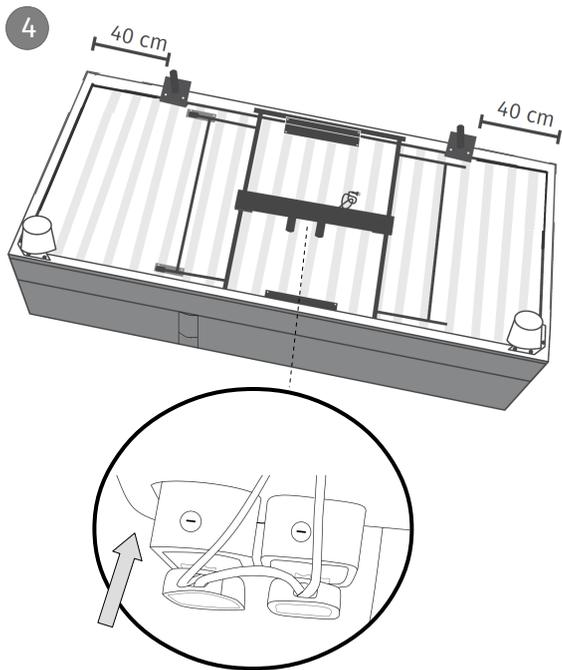
4 Die Eckfüße mit der Gewindestange an die Seiten mit der Tasche für die Fernbedienung anschrauben.
