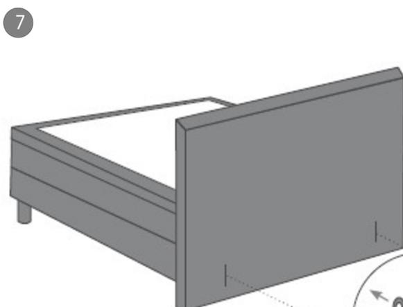
7 Das Kopfteil kommt an die Seite, wo die Löcher in der Huse sind. Durch Abtasten das Bohrloch finden. Dann die Gewindeschrauben mit der Unterlegscheibe von hinten durch den Kopfteilkorpus anschrauben.
