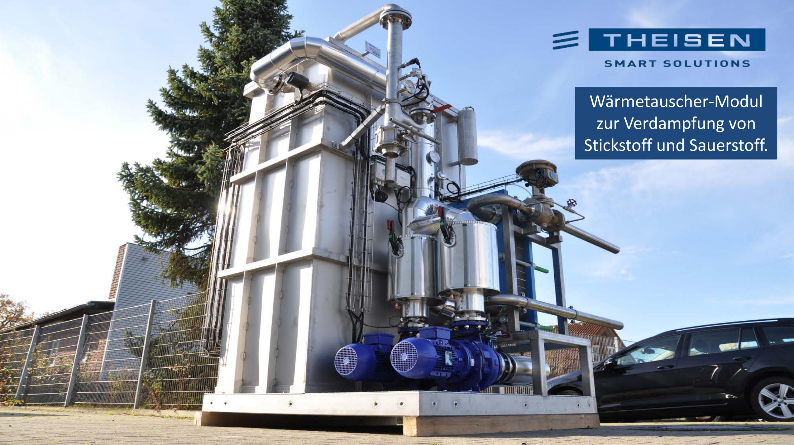
Wir haben die Anlage entworfen, die Komponenten entwickelt und gebaut. Alle Module wurden von uns zu einem komplexen Produkt zusammengesetzt. Deshalb ist es für uns selbstverständlich, dass wir auch die Montage vor Ort übernehmen und die Anlage beim Kunden aufbauen.
