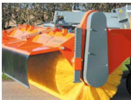
Kettenkasten (seitlicher Kettenantrieb)
