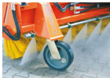
Stabile Super-Elastik-Vollgummiräder mit Gussradkörper, Hochdruckspülanlage
