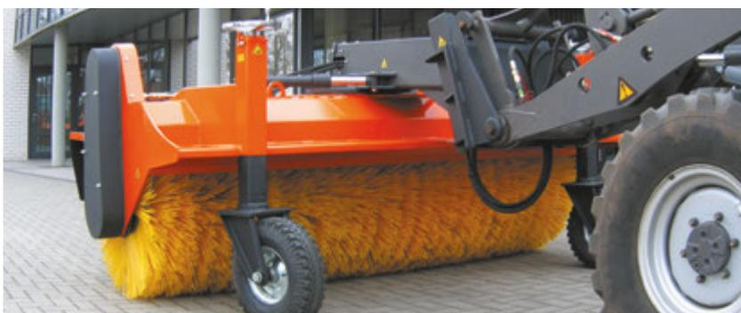
bema Jumbo am Radlader (Schnellwechselanbau mit 2D-Rollenniveaueausgleich)
