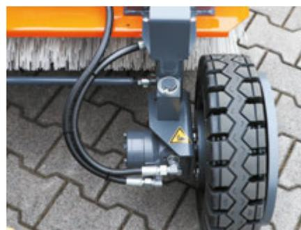
Effizienter lenkbarer Radantrieb (hydraulisch)
