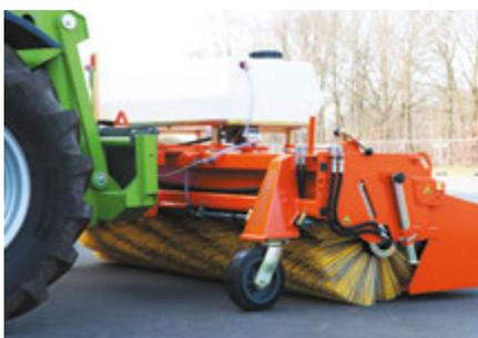
Stabile Super-Elastiklaufräder Ø 300 x 90 mm, Anbau Teleskopklader
