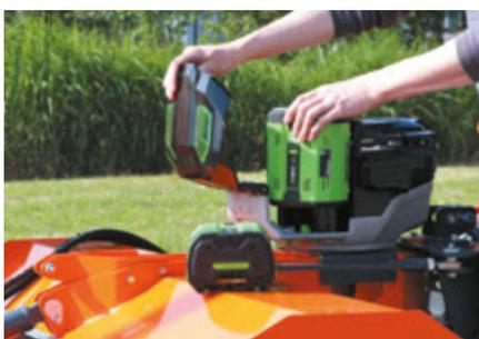
EGO Power E-Motor mit zwei leistungsstarken 56V-ARC-Lithium™-Akkus
