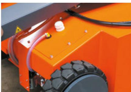
Maschinengehäuse mit integriertem Wassertank inkl. Füllstandsanzeige
