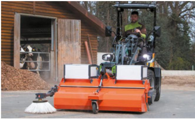
bema Sweezy® 580 Dual E ausgestattet mit einem mechanisch angetriebenen Seitenkehrbesen und einer Wassersprüheinrichtung mit 2 x 64 Liter Wassertanks
