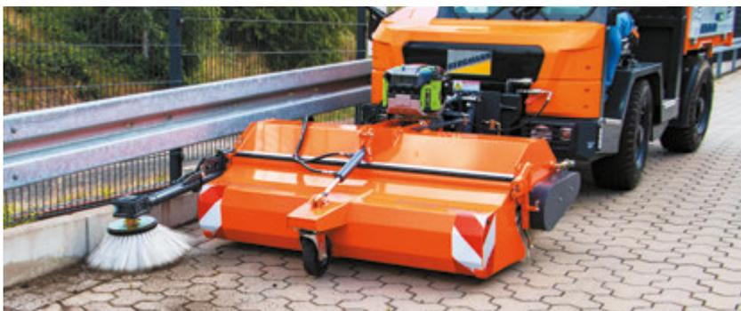
bema Sweezy® 580 Dual E mit mechanisch angetriebenem Seitenkehrbesen am E-Dumper
