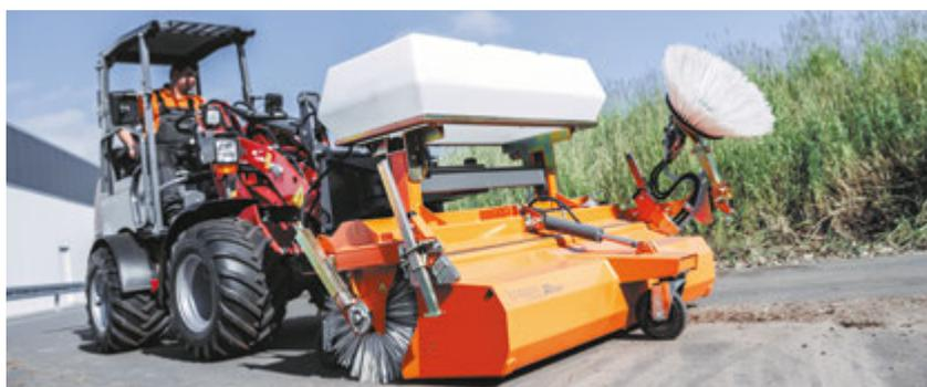
bema 20 Dual mit Wassersprüheinrichtung und Seitenkehrbesen
