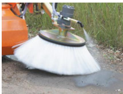
Seitenkehrbesen mit Wassersprüheinrichtung
