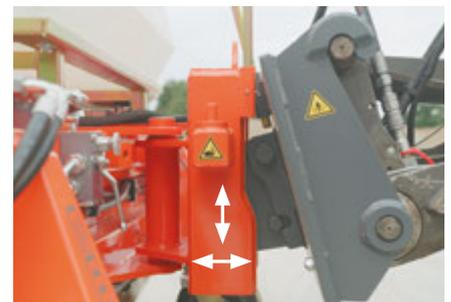
3D-Ausgleich und optionales Drehgelenk zur Erweiterung des 3D-Ausgleichs
