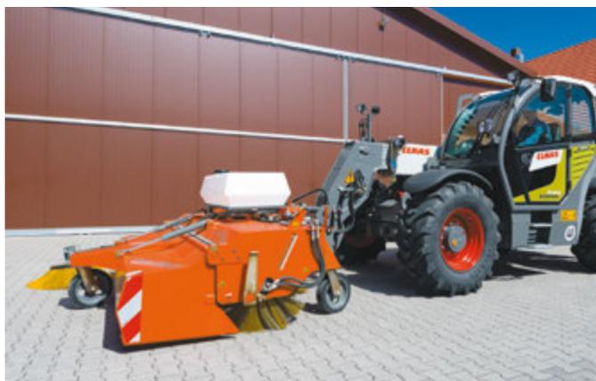
bema 75 Dual PowerMaster am Teleskoplader Schnellwechelanbau
