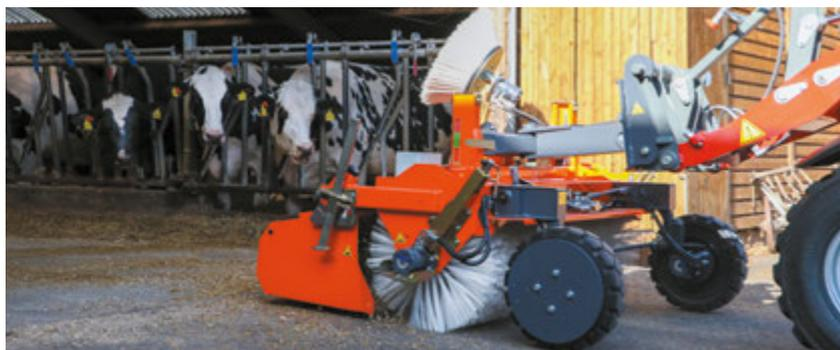
Mit zwei lenkbaren Radantrieben ist die Kehrmaschine unabhängig vom Trägerfahrzeug
