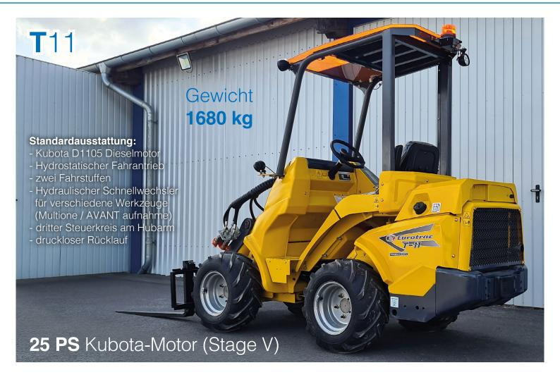
Der neue Teleskop-Hoflader T11 ist sehr wendig und hat durch den neuen Teleskoparm eine große Hubhöhe. Durch den Teleskoparm und durch die Knicklenkung bietet sich der Hoflader für verschiedenste Einsatzzwecke an. Die kompakte Bauweise garantiert eine hohe Wendigkeit und gleichzeitig einen einfachen Transport des Geräts.
