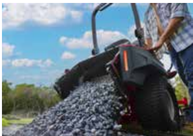
Das einzige rückseitige Ladebett der Branche mit hydraulischer Unterstützung. 136 kg Nutzlast.
