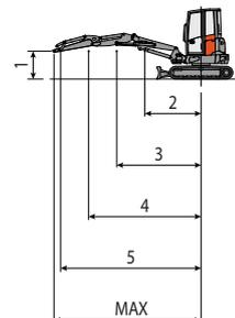
Hebekraft basierend auf ISO-Norm 10567 und überschreitet nicht mehr als 75% der Kippplast oder 87% der hydraulischen Hebe-Kapazität der Maschine.
