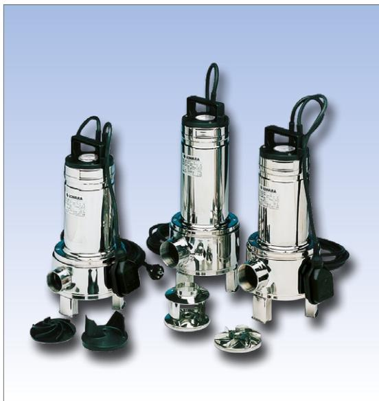
Die Tauchpumpen zur Förderung von Medien mit Feststoffanteilen. Ausführung in Edelstahl sowohl mit Zweikanal- als auch mit Vortex-Laufrad. Mit oder ohne Kabel- oder Rohr-Schwimmerschalter. Entleerung von Sammeltanks für Regenwasser, Sickerwasser und Abwasser aus Wasch- und Geschirrpülmaschinen. Entleerung von Kellern, Garagen und überfluteten Räumen. Förderung von Brauchwasser, inkl. faserige Schwebestoffe. Springbrunnen.
