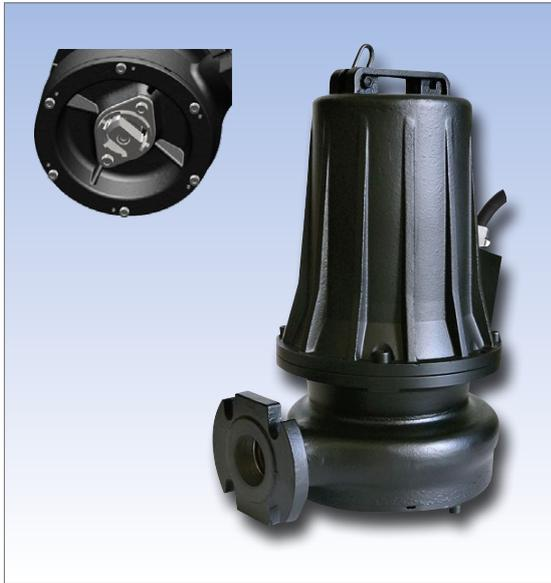
Die G Pumpe verfügt über ein Zerkleinerungssystem für Feststoffe im Pumpeneinlass. Sie werden häufig dann verwendet, wenn Flüssigkeit mit Feststoffen über Leitungen relativ kleinen Durchmessers gepumpt werden soll, welche bereits installiert sind. Anwendungsbereiche: Haushaltskanalisation, Flüssigkeiten mit Feststoffen, immer wenn eine grosse Förderhöhe verlangt wird.
