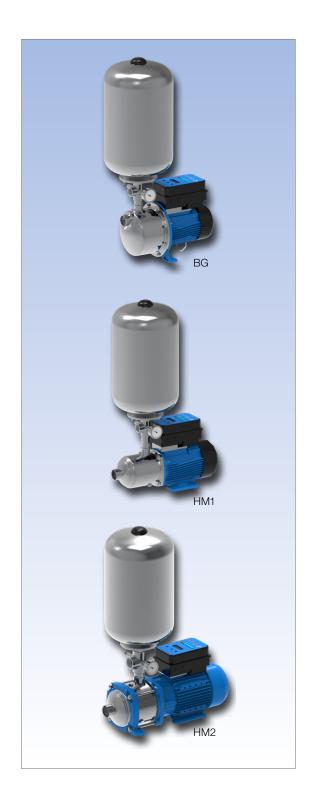
ResiBoost ist ein intelligentes Konstantdrucksystem für die Hauswasserversorgung. Eine Komplettlösung besteht aus einer Lowara Edelstahlpumpe, einem Drehzahlregelgerät und einem kleinen Membranbehälter. Das System ist auf konstanten Druck eingestellt, leicht zu installieren und zu bedienen. Der ResiBoost ist geschützt gegen Überstrom, Über-/Unterspannung, Kurzschluss und Trockenlauf. Er kann bei Ausfall des Steuerelements manuell überbrückt werden.
