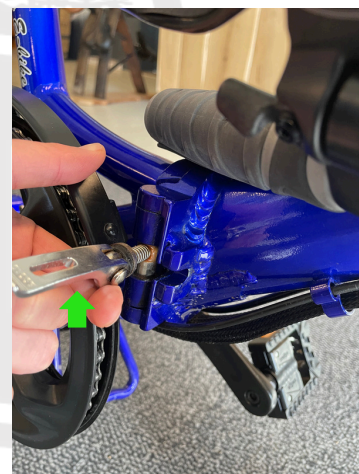
Schnellverschluss nach oben drücken
