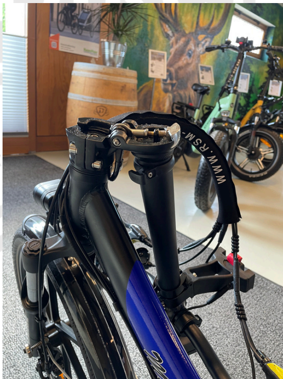
Lenker nach unten klappen
