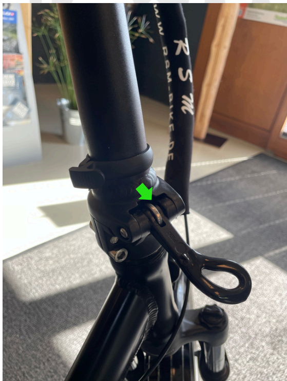
Schnellverschluss nach unten ziehen
