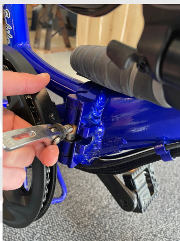
Schnellverschluss nach links schieben
