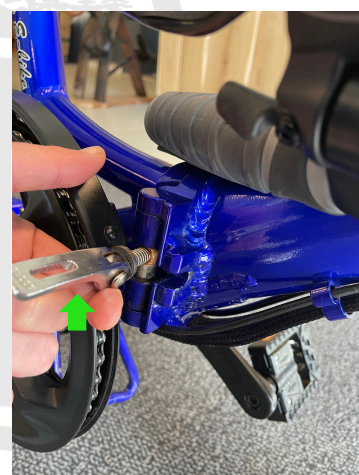
Schnellverschluss nach oben drücken
