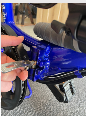
Schnellverschluss nach links schieben
