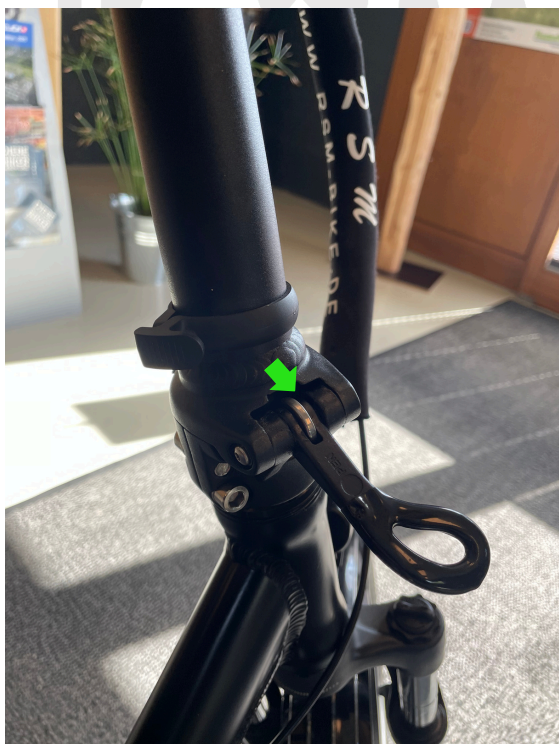
Schnellverschluss nach unten ziehen
