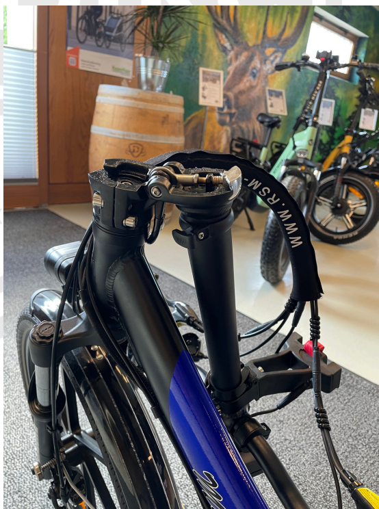
Lenker nach unten klappen
