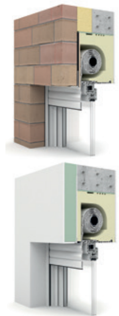
Komplett überputzbare Außen- und Innenblende für Putz- und Klinkerbauten.
