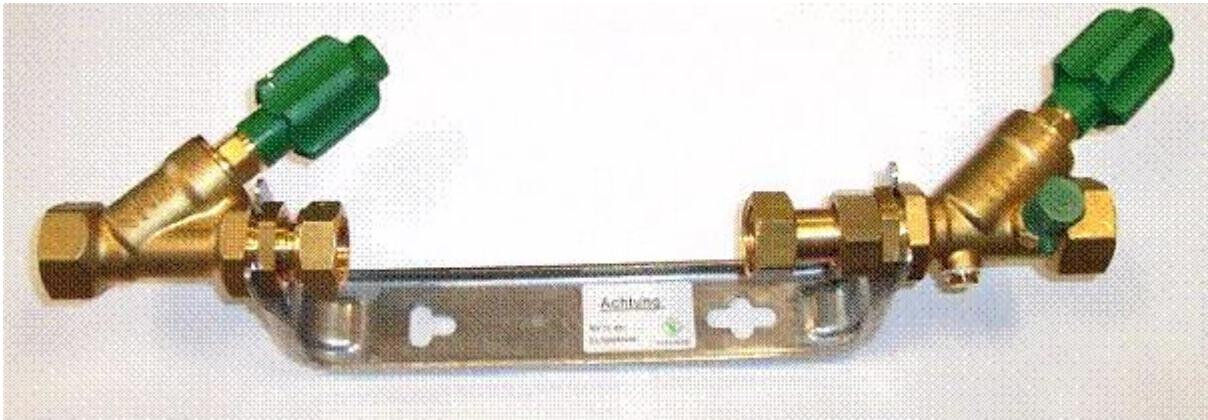
**Im Innenbereich ist eine Anschlussgarnitur QN 2,5 mit Rückflussverhinderer einzubauen. Zählerbaulänge 190 mm, DN 20**
