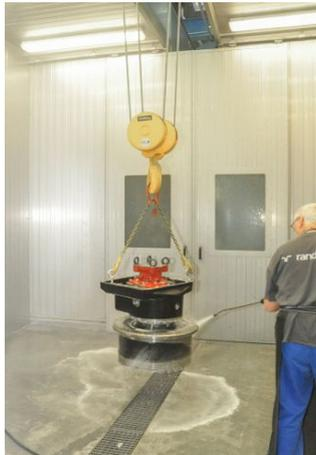
Abb. 3 u. 4 Washkabine für die Reinigung von Großbaugruppen
