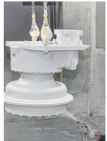
Abb. 9 u. 10 Maskierplatz und anschließende manuelle Beschichtung
