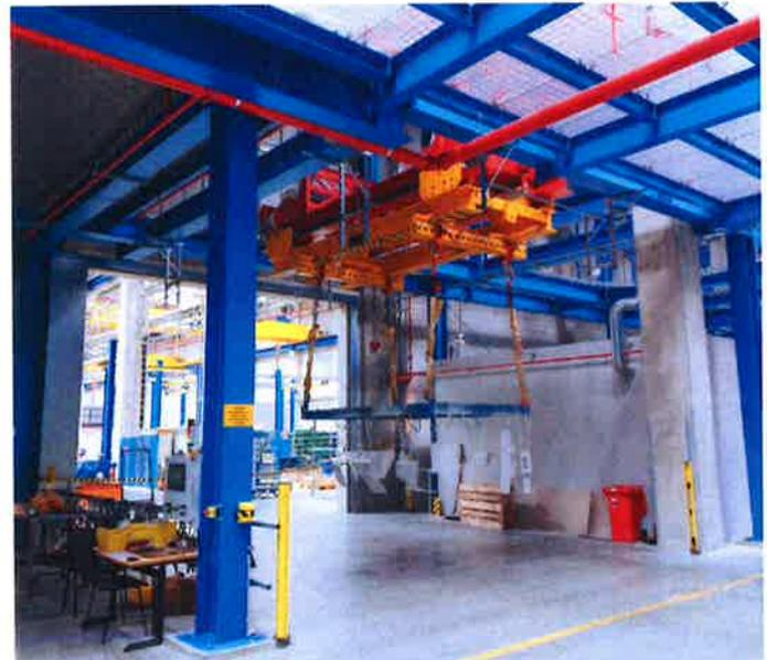
Mehrere Auf- und Abnahmestationen befördern die Werkstücke vom Erdgeschoss zwölf Meter nach oben auf die Höhe der Kranbahn im ersten Stock.
