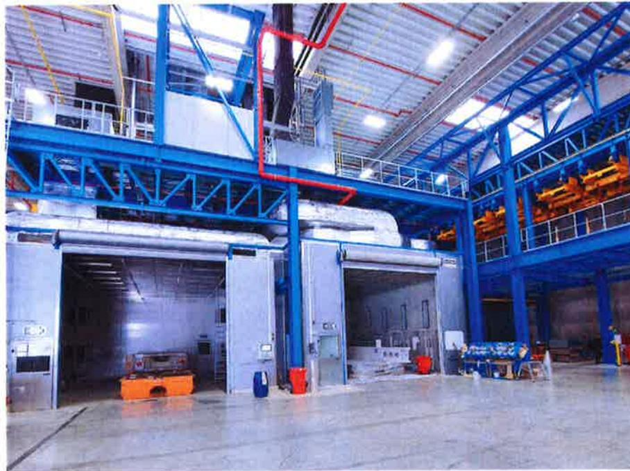
Durch die Verlegung der Reinigungs-, Lackier- und Trocknerkabinen in den ersten Stock bietet das Erdgeschoss genügend Platz für die manuelle Großteillackierung bis 100 Tonnen sowie für Lagerplätze, Laufwege und das Lacklager.
