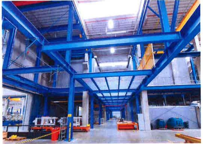
Unten Logistikfläche, oben Lackieren: Für KMT KraussMaffei entwickelte Vollert eine äußerst platzsparende zweistöckige Lackieranlage für Großteile bis 30 Tonnen.
