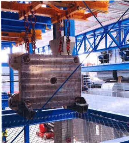
Spezielle Fangnetze sichern den Arbeitsbereich im Erdgeschoss im Notfall gegen herabstürzende Werkstücke. Fotos: Vollert
