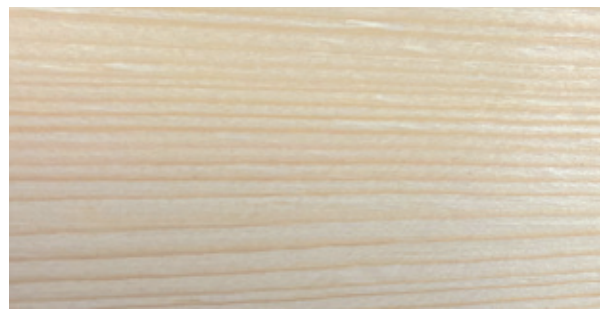
Rohdichtenbereich von 400-500 kg/m 3 (mittlere Rohdichte 460 kg/m 3 )
