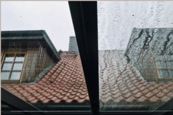
Links mit Beschichtung - Rechts ohne Beschichtung
