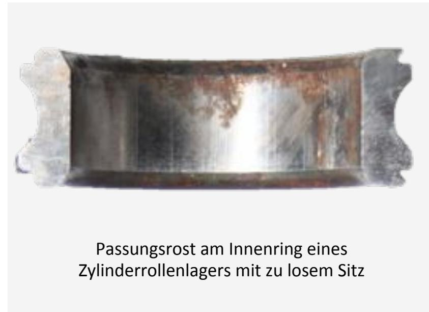
Passungsrost am Innenring eines Zylinderrollenlagers mit zu losem Sitz
