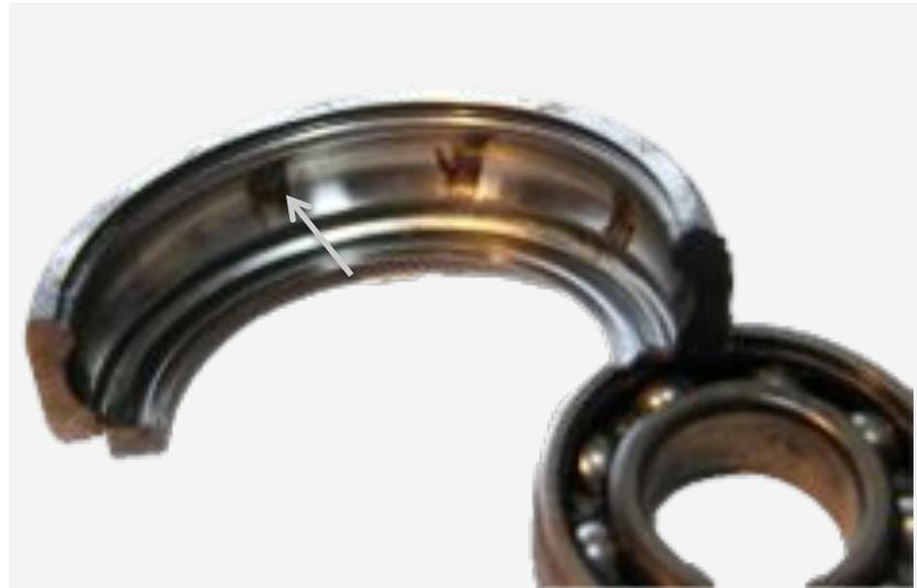
Kugleindrücke in den Schultern eines Rillenkugellagers. Das Montagewerkzeug wurde am lose gepassten Ring angesetzt und damit sind die Kräfte über die Kugeln geleitet worden.
