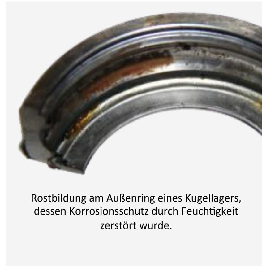
Rostbildung am Außenring eines Kugellagers, dessen Korrosionsschutz durch Feuchtigkeit zerstört wurde.
