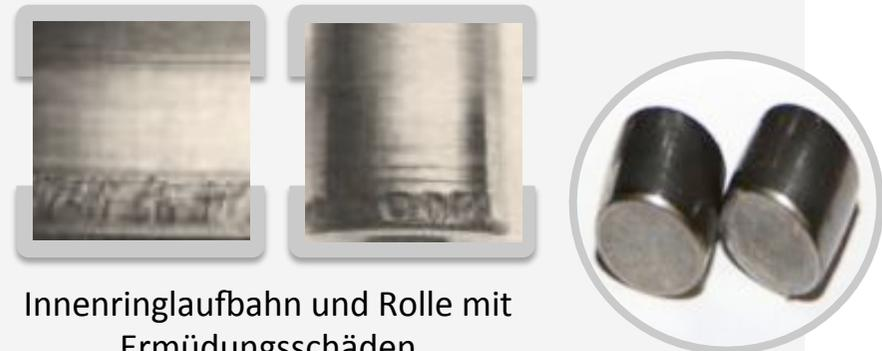
Innenringlaufbahn und Rolle mit Ermüdungsschäden
