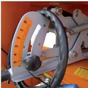
hydr. Schieberöffnung einfachw. mit Absperrhahn
