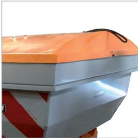
Gfk-Abdeckung mit Spanngummi
