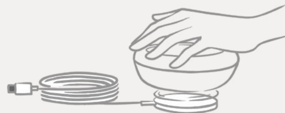
Ilustracja 4: Ładowanie urządzenia LIVATY Lume za pomocą ładowarki LIVATY Lume Qi-Charger.
