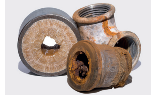
Kalk und Rost an Rohren
