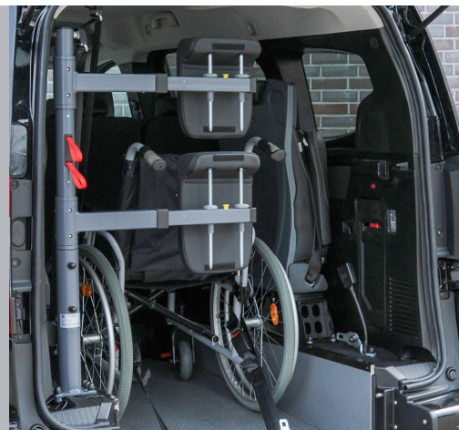
Das Fahrzeug kann mit der Kopf- und Rückenstütze FUTURESAFE 2.0 ausgestattet werden.
