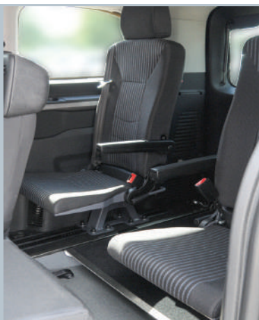
Des sièges pivotants et rabattables (optionnels) en 3e rangée permettent une utilisation flexible du véhicule.
