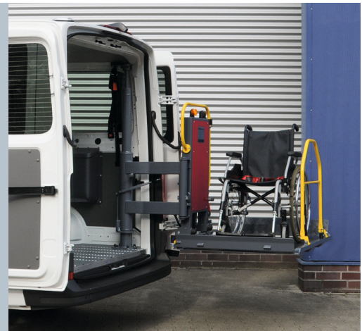
L'élévateur pivotant BSL 350 de Warpel en cours de levage du fauteuil roulant
