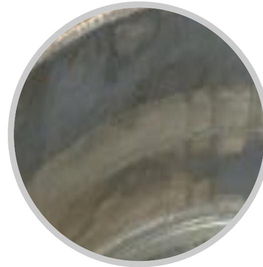
Lagergehäusepassung durch von Mikrogleitbewegung hervorgerufenen Passungsrost bzw. Reibkorrosion beschädigt
