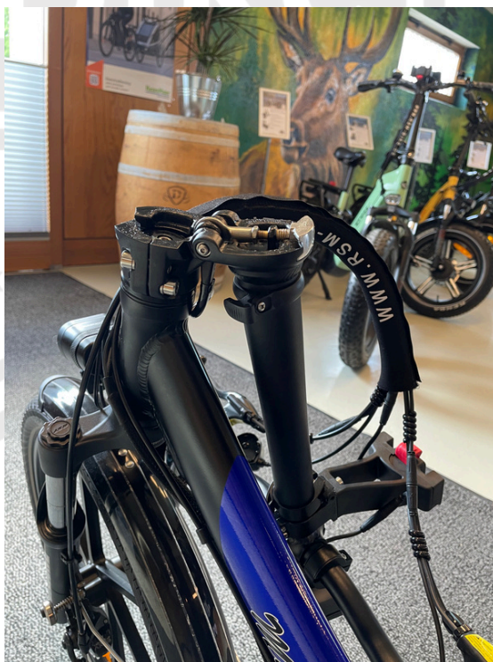
Lenker nach unten klappen
