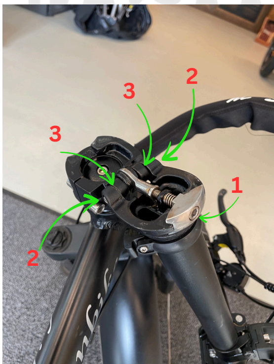
Lenker nach unten klappen
