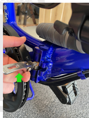
Schnellverschluss nach oben drücken
