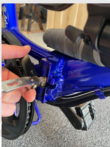
Schnellverschluss nach links schieben
