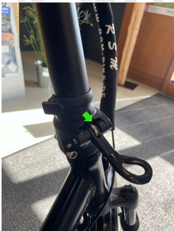
Schnellverschluss nach unten ziehen
