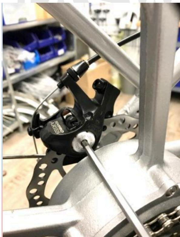
Drehen Sie die Inbusschraube heraus, um die rechte Seite der Bremse komplett zu lösen
