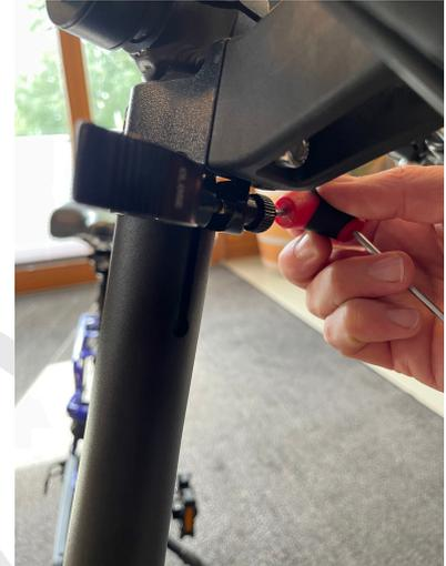
Überprüfen Sie die Festigkeit des Schnellverschlusses. Falls erforderlich, blockieren Sie die Sechskantmutter zum Beispiel mit einem Schraubenzieher, und ziehen den Schnellverschluss nach.
