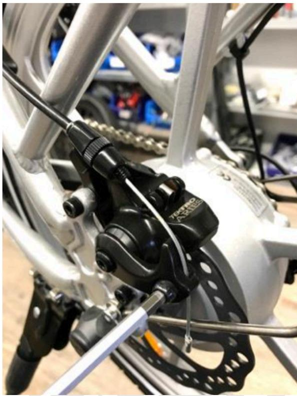
Lösen Sie den Seilzug, um die linke Seite der Bremse komplett zu öffnen
