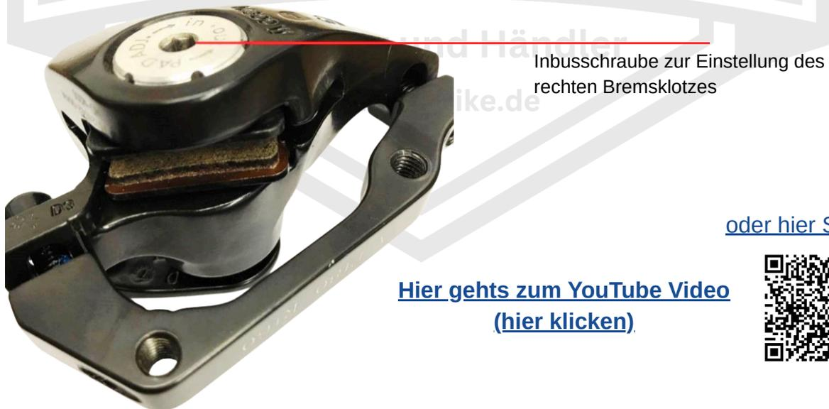
Nach einem Wechsel der Bremsklötze müssen Sie die Bremse ebenfalls nachstellen.
