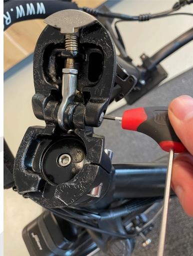
Überprüfen Sie auf beiden Seiten die Festigkeit der beiden Inbusschrauben und ziehen Sie sie gegebenenfalls etwas an.
