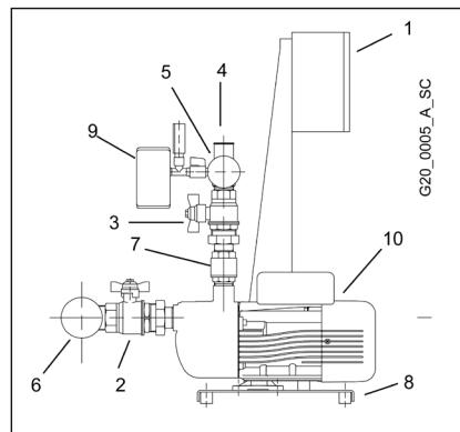
Suivant le type de groupe la soupape de retenue peut être sur le refoulement ou sur l'aspiration, l'électropompe peut être de type vertical ou horizontal.
