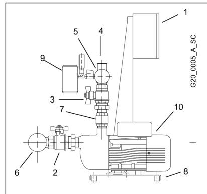
A seconda del tipo di gruppo la valvola di ritegno può essere in mandata o in aspirazione, l'elettropompa può essere del tipo verticale od orizzontale.
