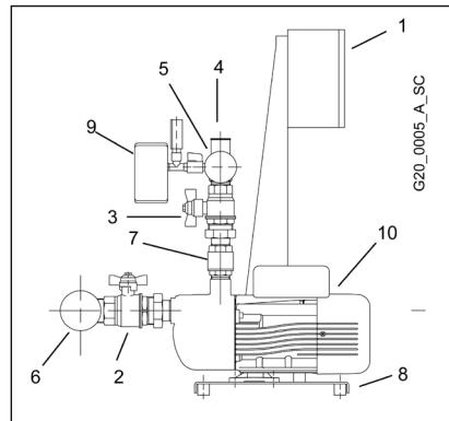
Según el tipo de grupo, se puede instalar la válvula de retención en impulsión o en aspiración y la electrobomba puede ser de tipo vertical u horizontal.
