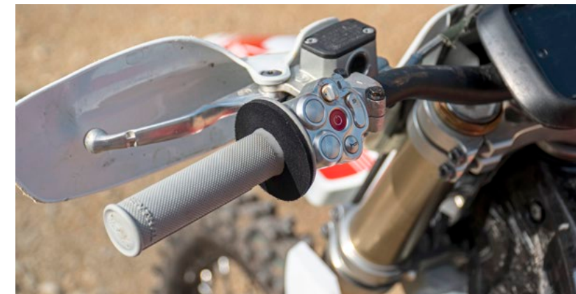
Knöpfchen: Menüsteuerung über den roten Button und die beiden linken. Das rechte Trio bedient Licht, Hupe und Blinker
