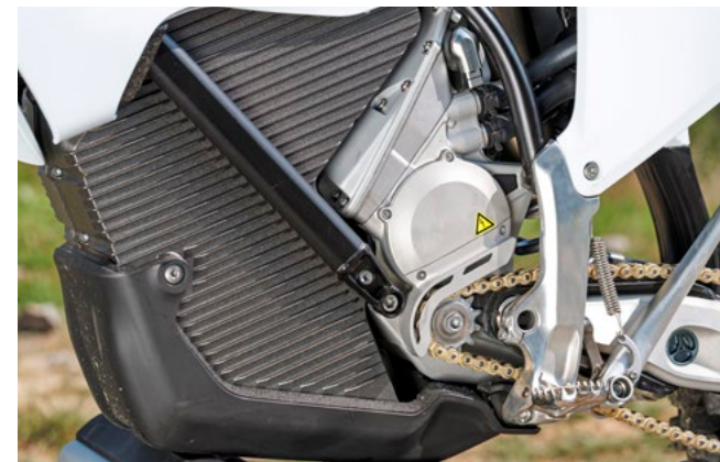
Klein: Hinter dem Akku (grau) und unter dem Inverter (silber, rechteckig) wirkt der E-Motor (silber, rund) unscheinbar
