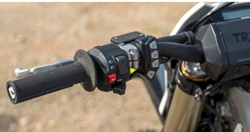
Multiple Choice auch bei Verbrennern: Schalter für Launch Control, Quickshifter, Traktionskontrolle, Mapping (von oben)
