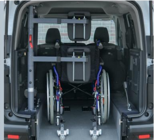
Le véhicule peut être équipé de l'appui-tête et de l'appui-dos FUTURESAFE 2.0.
