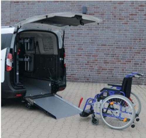
Lorsque la rampe est dépliée, le véhicule peut être facilement accessible en fauteuil roulant.
