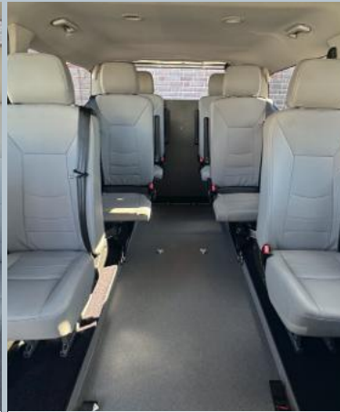
Dreh-Klappsitze ermöglichen eine flexible Nutzung des Fahrzeuges.
