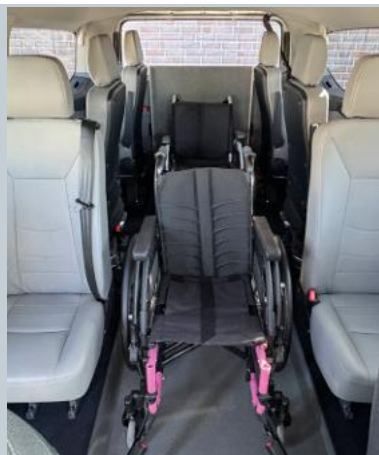
La place avant pour fauteuil roulant est entièrement intégrée à la conduite.
