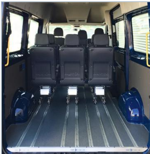
Le système Smartfloor en aluminium permet une utilisation flexible du véhicule
