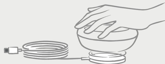
Ilustracja 4: Ładowanie urządzenia LIVATY Lume za pomocą ładowarki LIVATY Lume Qi-Charger.
