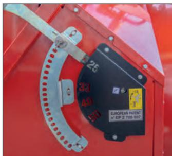
Schnittlängeneinstellung von 250 - 520 mm einfach und ohne Werkzeug möglich. Kein Trommelwechsel notwendig.
