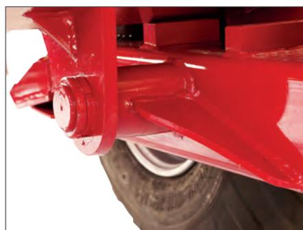
Robuste Achsbolzen (70 x 405 mm)
