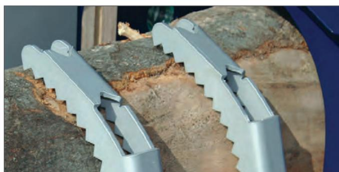
Durch den Niederhalter wird das Drehen des Holzes verhindert und der Stamm kann sicher gehalten werden, sodass auch das letzte Stück des Stammes richtig in den Spaltkanal fällt.
