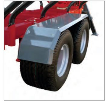
40 km/h für Forest-Master RW möglich; Druckluft und Kotflügel erforderlich
