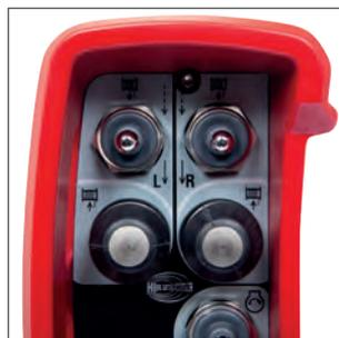
**Getrennte Bedienelemente für Einziehen / Abspulen.** Die Funktionen Einziehen und Abspulen werden bei patrol-Steuerungen über getrennte Bedienelemente aktiviert, um ein versehentliches Verwechseln zu vermeiden.
