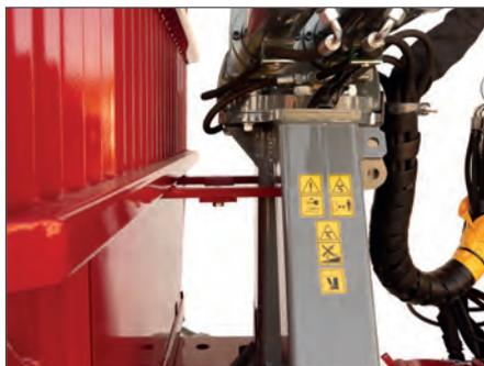
Schutzgitter zum Kran hin abgestützt
