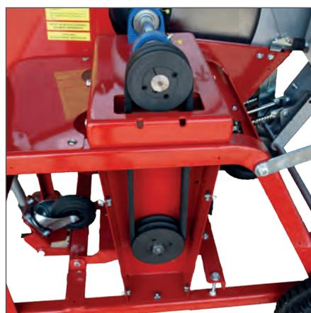
Keilriemenantrieb bei WSA-700 PE
