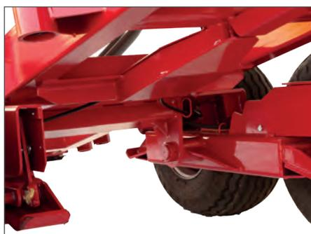
Robuste Achsbolzen (70 x 400 mm) mit Verstärkung
