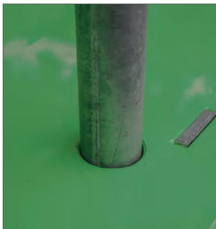
Rungentaschen und Zurrösen im Brückenboden eingearbeitet
