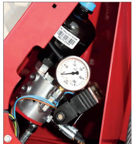
Eigenes, integriertes elektrohydraulisches System
