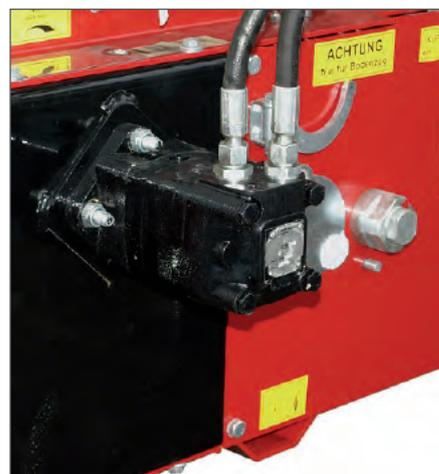
Hydraulischer Antrieb - lose
