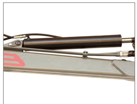
Schlauchbruchventil bei Knickarm, Hauptarm und Abstützung
