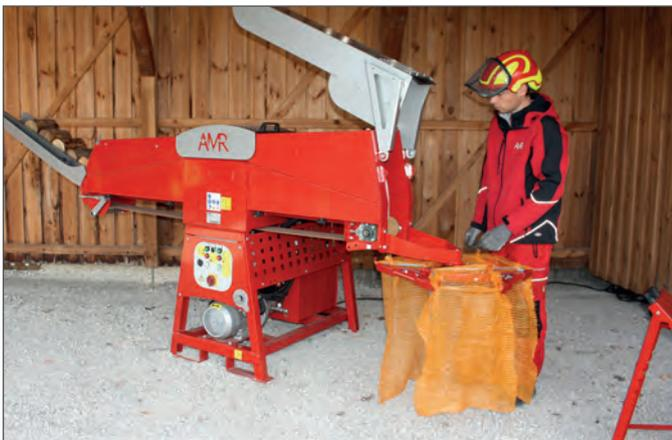
Rotabagga-Absacksystem für ergonomisches Arbeiten.
