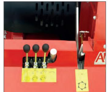
Stufenlose Geschwindigkeitsregelung und Notabschaltung
