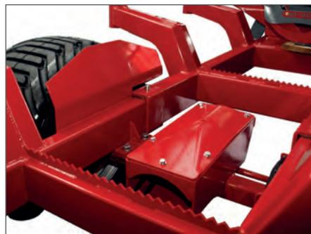
Rahmen mit Achse um 1 m ausziehbar
