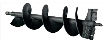
Erdbohrer mit Hartmetallzähnen (Zähne und Bohrspitze auswechselbar), Nutzlänge 1.000 mm, Bohrkopf 2-schneidig, gepanzert und verstärkt
