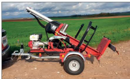
Mit dem Straßenfahrwerk ist der VMR sicher zu transportieren.
