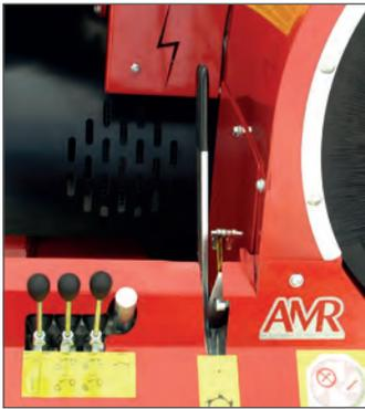
Nothebel Sägenantrieb (zur Riemenentspannung)
