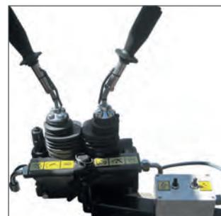
On/Off-Spezialsteuerung (4 Sektionen am Traktor, 4 Sektionen fest am Kran)
