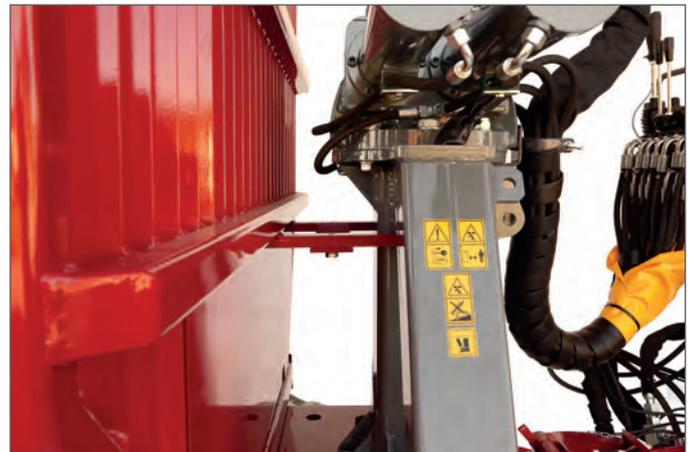
Schutzgitter zum Kran hin abgestützt
