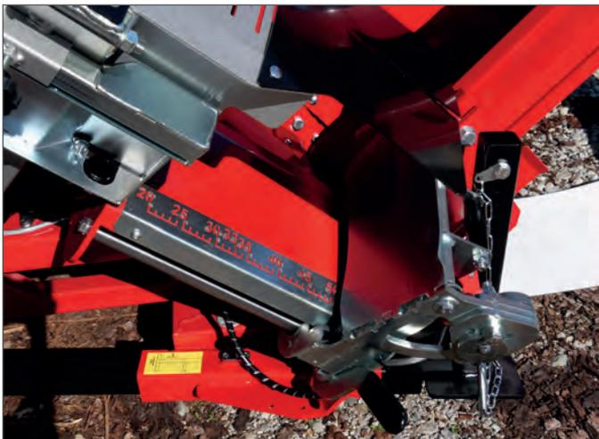
Verstellbarer Längenanschlag mit Feinstufen von 200 - 520 mm
