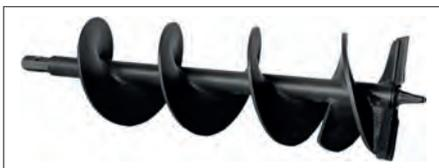
Erdbohrer mit Flügelschneiden (Schneiden und Bohrspitze auswechselbar), Nutzlänge 1.000 mm, Bohrkopf 2-schneidig und gepanzert
