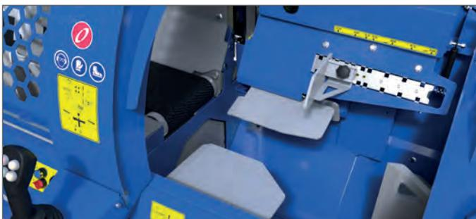
Der hydraulische Längenbegrenzer ist von 250 - 500 mm verstellbar. Der Begrenzer kommt bei jedem Vorschub etwa 50 mm gegen den Stamm und beim Auslösen des Vorschubes wieder zurück in die Ausgangsposition. Zwei Abwurfklappen öffnen selbstständig und sorgen für sicheres und richtiges Hinabfallen des Holzes.
