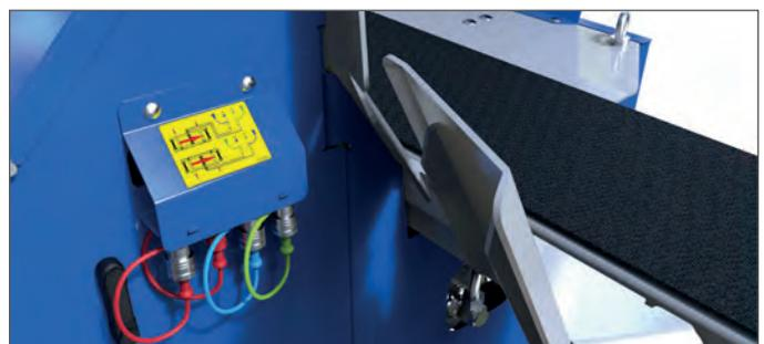
Hydraulischer Ausgang für das RCA-Zubehör wie z. B. Längs- und Querförderer RN 5000 und DM 2000.
