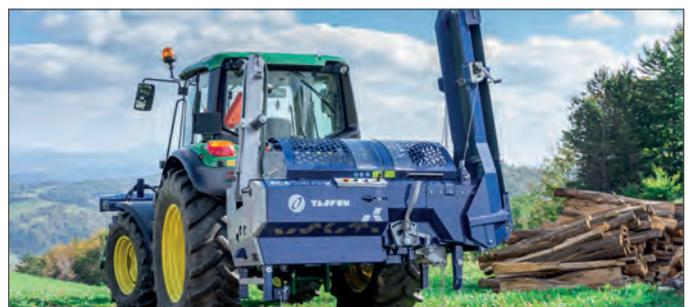
Für den Transport können das Vorschubband und das Förderband aufgeklappt werden.
