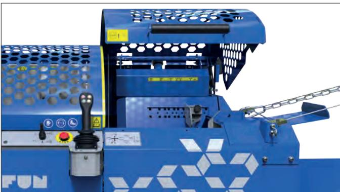
Durch das Öffnen der Schutzhaube sind alle Maschinenfunktionen außer Betrieb.
