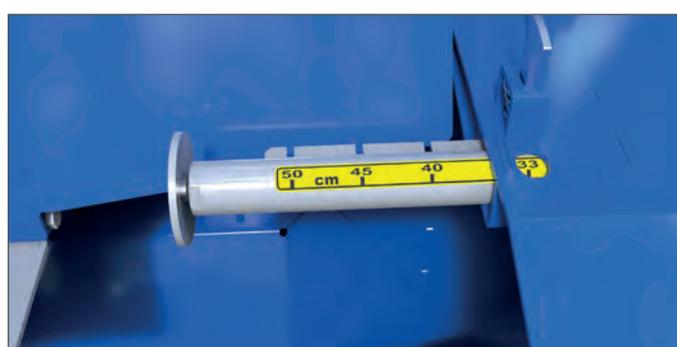
Der RCA 380 hat einen innovativen Längenbegrenzer, der von 250 - 500 mm verstellbar ist. Die Anschlagplatte kommt bei jedem Vorschub etwa 50 mm vorwärts gegen den Stamm und fährt dann wieder zurück in die Ausgangsposition, damit das durchgesägte Holzstück sicher in den Spaltkanal fällt.
