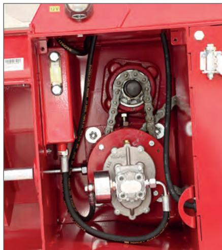
Antrieb der Hydraulikpumpe über Getriebe mit Druckfilter
