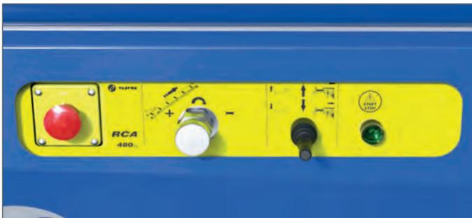
Links befindet sich der Not-Aus Schalter. Über den Drehknopf in der Mitte wird die Geschwindigkeit des Förderbandes eingestellt und mit dem rechten Schalter lassen sich die Anbaugeräte bedienen (bei RCA 480 JOY / PRO 500).
