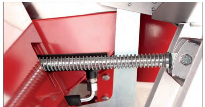
Wippe mit Hydraulikzylinder
