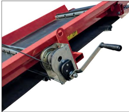
Winde zur stufenlosen Neigungseinstellung des Förderbandes
