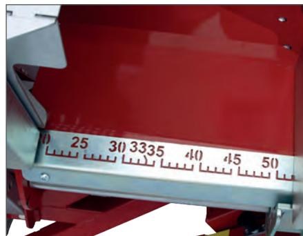
Verstellbarer Längenanschlag mit Feinstufen von 200 - 520 mm
