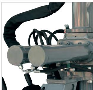
Schwenkwerkgehäuse aus Stahl, 4 Schwenkzylinder
