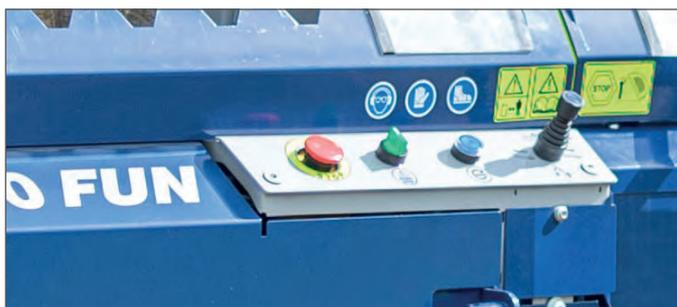
Der Mini-Joystick sorgt für eine ergonomische, sichere und einfache Bedienung der Grundfunktionen (Vorschub links-rechts, Sägen, Spalten).
