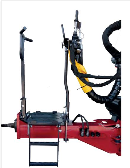
Stehplattform bei Druckluftbremse
