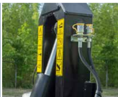
Nützliche Zusatzausstattung: Hydraulikanschlüsse auf dem Haken
