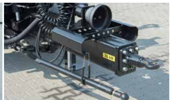
Zwangslenkung (in Fahrrichtung rechts) zur erleichterten Manövrierung
