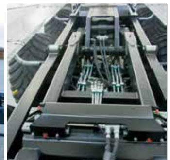
Stabile Rahmenkonstruktion und hydraulische Containerverriegelung garantieren die Sicherheit während der Fahrt
