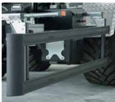
Sicherheitsoptimierung mittels seitlichem Unterfahrschutz
