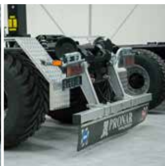
Hydraulisch erleichterte Bedienung des ausziehbaren Unterfahrschutzes
