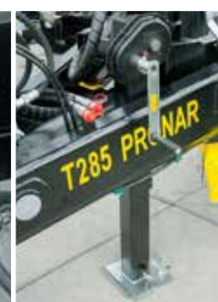
Teleskopstützfuß mit Getriebe
