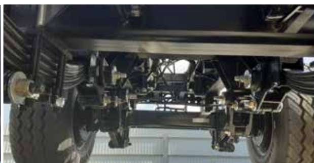
Tandemfahrwerk mit Parabelfederung beim T185/1 zur Optimierung des Fahrkomforts
