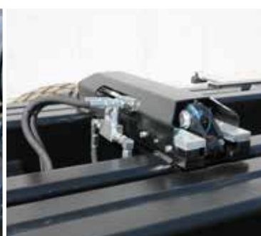
Hydraulische Containerverriegelung zur optimalen Sicherung des Containers
