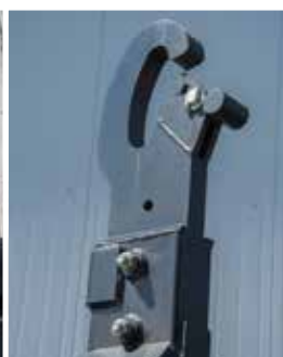
Haken mit zwei höheinstellbaren Positionen und automatischer Containerverriegelung
