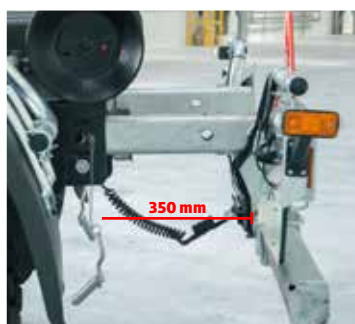
Hinterer Unterfahrschutz mechanisch in drei Positionen einstellbar (abhängig von der Containerlänge)
