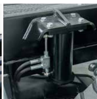
Hinterachsabstützung zur Absicherung während der Verladung
