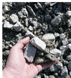
Grave concassée / couche de fondation minérale
