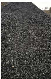
Grave concassée / couche de fondation minérale
