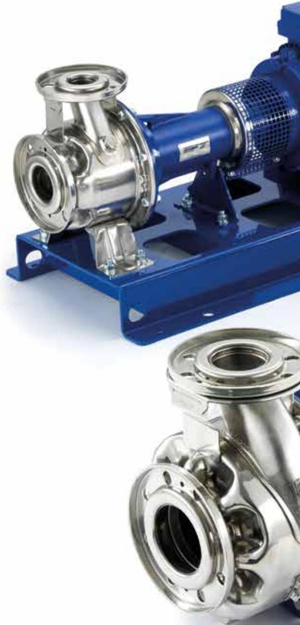
Die Lowara e-SH ist eine einstufige Norm-Kreiselpumpe nach EN 733 aus Edelstahl 1.4404. Dank der Pull-Back-Konstruktion können Laufrad, Adapter und Motor ausgebaut werden, ohne das Pumpengehäuse aus der Rohrleitung zu entfernen.
