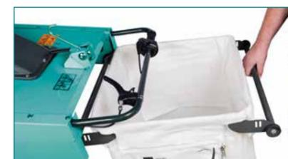
Hebel umlegen, Auffangbehälter abnehmen – ganz einfach dank patentierter XP Entleerungstechnik. Bei Entnahme wird der Motor automatisch ausgeschaltet. Jetzt QR-Code scannen und Video anschauen zur schnellen Fangsackentleerung.
