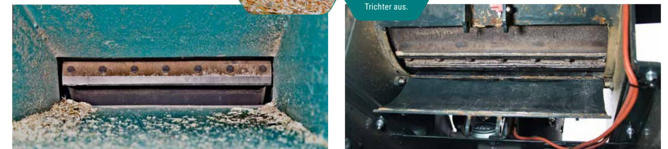
Schneidsystem/Trommel – Zwei Wendemesser sorgen für einen sauberen einziehenden Schnitt. Stumpfe Messer können einmal gedreht werden.
